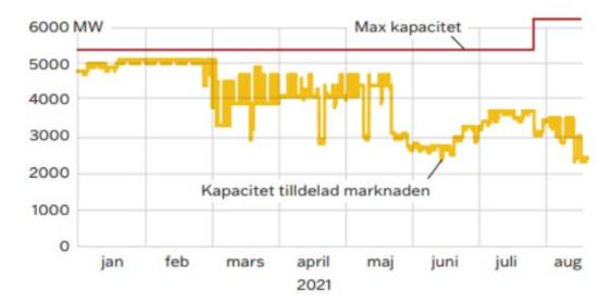
Tilldelad överföringskapacitet från SE3 till SE4. Den 27 juli 2021 togs Sydvästlänken äntligen i bruk. Den utbyggda överföringskapaciteten från SE3 till SE4 steg med det betydligt, men den överföringskapacitet som tilldelades av Svenska kraftnät sjönk.
